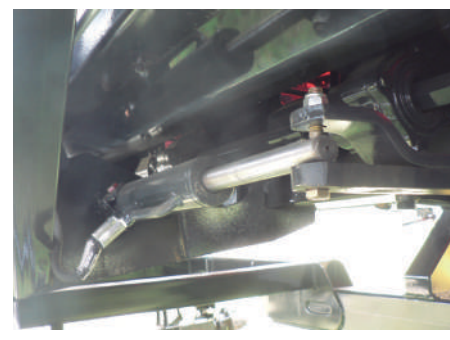
Regulación de Chapa. Opcional: sistema hidráulico.
