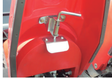
Sistema de traba de puntón a resortes. Disminuye el tiempo de pasaje de posición de trabajo a transporte y viceversa.
