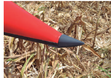
Puntera plástica para todo tipo de cultivos. Especial para maíz volcado.
