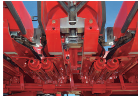
Sistema de rolos en voladizo. Sin bancadas ni puntos de lubricación. Placas gramilleras regulables. Sistema de cuerpos anclados con grampas que facilitan variar la distancia entre líneas.
