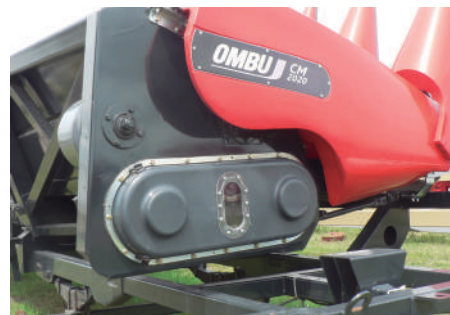
Transmisión en baño de aceite con cadena ASA 80 con tres variaciones de velocidad de acuerdo al avance de la cosechadora.
