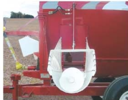
Sistema de accionamiento de guillotina y descenso de la batea de descarga.
