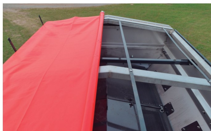
Lona cobertora enrollable con sistema de plegado y arcos para mantener intacta la calidad del producto a aplicar.
