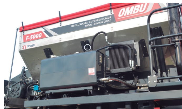
Depósito de aceite y radiador
