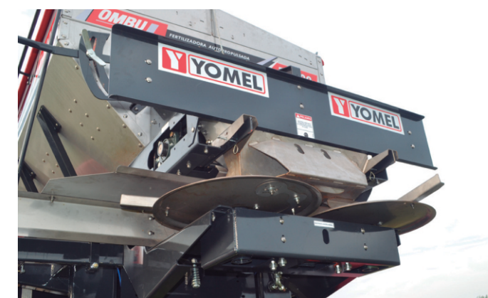
Sistema de distribución Bidisco con paletas móviles para ajuste del perfil de distribución completamente construido en acero inoxidable. Ancho de labor: 36m en granulados – 14m en polvos.
