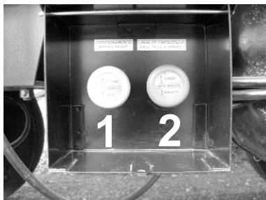
Dispositivo de accionamiento manual de bloqueo y desbloqueo del sistema de frenos.
